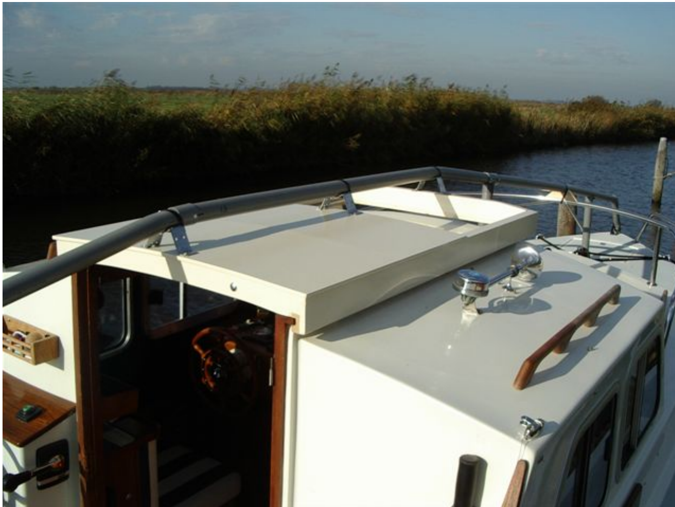
Winterkleed met ondersteuning van PVC buis
